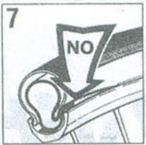
La chambre à air ne doit en aucun cas être coincée entre la jante et le pneu.
