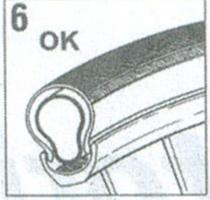
Après avoir gonflé légèrement la roue (1bar/15 psi), vérifier si la chambre à air est correctement positionnée à l'intérieur du pneu. (En faisant touner la roue le pneu ne doit pas faire de zig-zag.)
